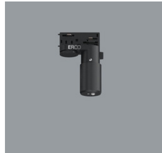
55249.000 ERCO Casambi Bewegungsmelder mit Lichtsensoren für ERCO Stromschienen 220-240V. Einrichtung über Casambi App (Android/iOS) mit Bluetooth Low Energy (BLE) fähigen Mobilgeräten. Anwendung zur tageslichtabhängigen Lichtsteuerung mit oder ohne Bewe- gungsmelder. Erfassungsbereich des Infrarot (PIR) Sensors 100°/ 5m. Bei 3m Raumhöhe ist dies ein Kreis von ca. 7m Durchmesser. 3-Phasen-Adapter für ERCO Strom- schiene 220-240V: Kunststoff, schwarz. Schwarz Gewicht 0,18kg CE RoHS
